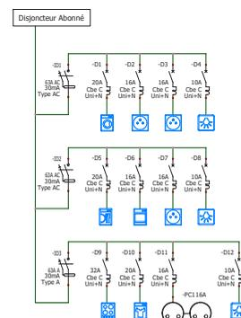
Les coffrets sont configurés à titre indicatif suivant les prescriptions de la norme NFC15-100 édition 2010, ils doivent être installés et adaptés en fonction des équipements prévus dans le logement.
