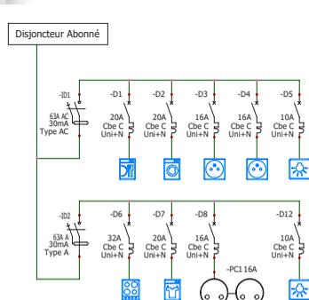
Les coffrets sont configurés à titre indicatif suivant les prescriptions de la norme NFC15-100 édition 2010, ils doivent être installés et adaptés en fonction des équipements prévus dans le logement.
