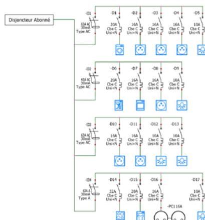
Les coffrets sont configurés à titre indicatif suivant les prescriptions de la norme NFC15-100 édition 2010, ils doivent être installés et adaptés en fonction des équipements prévus dans le logement.
