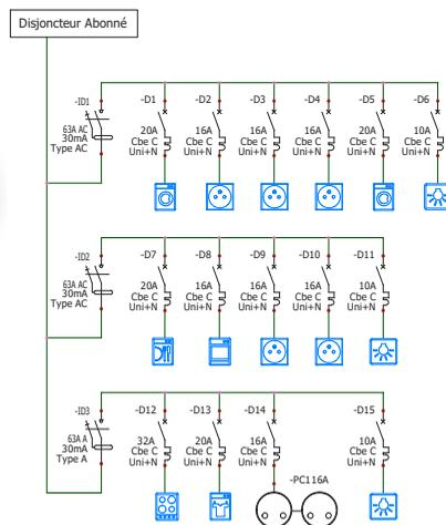
Les coffrets sont configurés à titre indicatif suivant les prescriptions de la norme NFC15-100 édition 2010, ils doivent être installés et adaptés en fonction des équipements prévus dans le logement.
