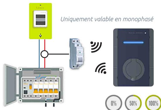
Afin de réaliser un délestage automatique, il est nécessaire d'ajouter dans votre tableau électrique un compteur d'énergie connecté sur l'arrivée principale. Ils pourront alors dialoguer ensemble et adapter la puissance de charge par rapport à l'énergie disponible.
