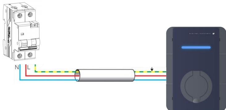
Une ligne dédiée doit être installée depuis le tableau électrique général avec sa protection différentielle et magnétothermique adaptée.
